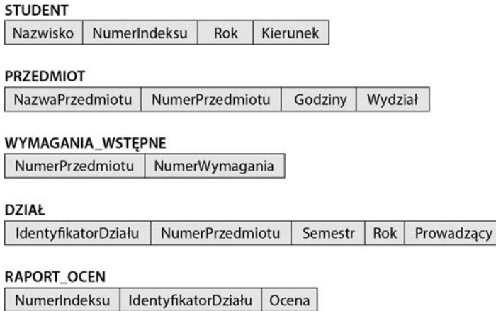
RYSunEK 2.1. Diagram schematu dla bazy danych przedstawionej na rysunku 1.2
