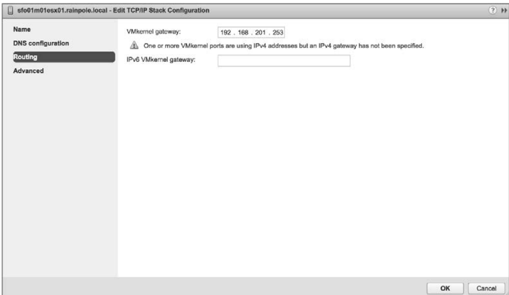
RYСУNEK 5.21. Każdy stos TCP/IP może mieć własną konfigurację DNS, własne informacje o routingu i inne zaawansowane ustawienia
