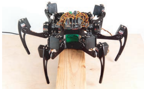
Rysunek 5.9. Zamontowane segmenty piszczelowe i serwowymotory wszystkich stawów ustawione pod kątem 90°
