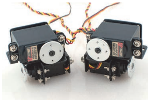
Rysunek 5.6. Zmontowane stawy biodrowe
