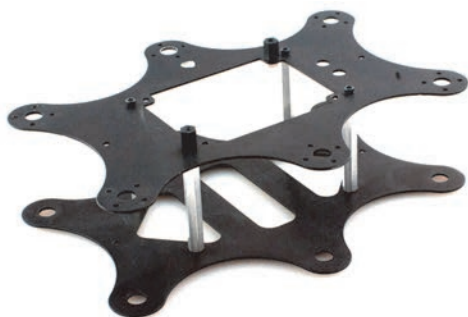
Rysunek 5.2. Zmontowany szkielet robota
