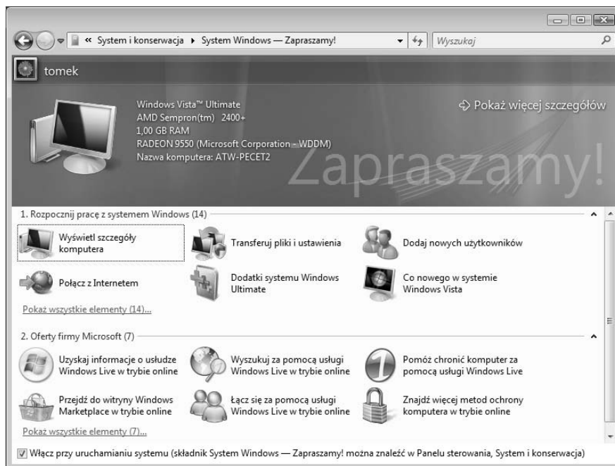
Rysunek 1.9. Składnik „System Windows — Zapraszamy!” w łatwym do znalezienia miejscu zawiera odnośniki do zadań, które pomogą Ci rozpocząć korzystanie z Windows Vista. Kliknij wybrane zadanie, a w górnym panelu pojawi się jego opis i odnośnik do niego. Kliknij ten odnośnik, aby rozpocząć. Domyślnie widoczne są tylko wybrane zadania. Aby zobaczyć cały zestaw, kliknij odnośnik Pokaż wszystkie elementy w sekcji Rozpocznij pracę z systemem Windows
