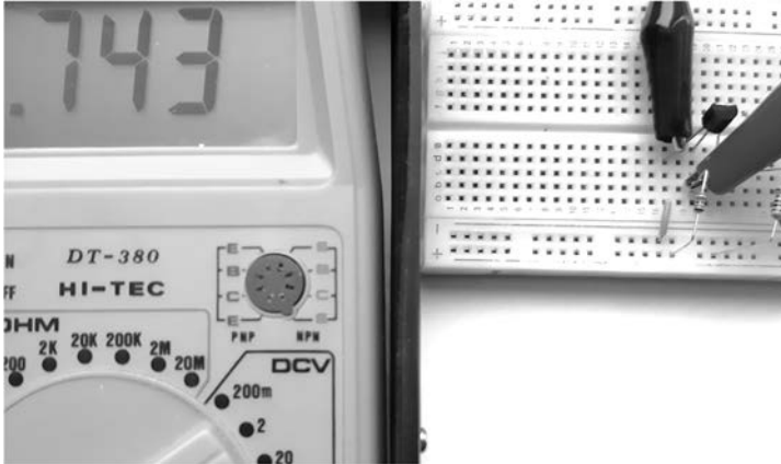
Rysunek 1.12. Napięcie na bazie. Na zakresie 2 V miernik wskazuje 0,743 V
