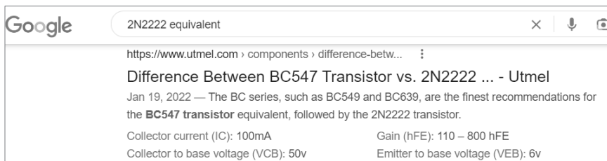
Rysunek 1.6. Wiele źródeł wskazuje, że zamiennikiem tranzystora 2N2222 jest BC547
