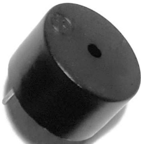
Rysunek 1.21. Przetwornik piezoelektryczny, podobnie jak dioda LED, powinien być odpowiednio spolaryzowany, aby generował dźwięk. Wyprowadzenie oznaczone plusem musi być podłączone do punktu o wyższym potencjale
