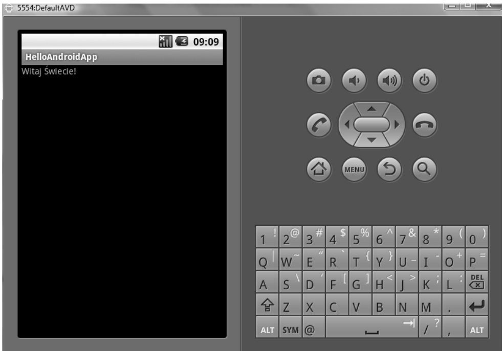
Rysunek 2.10. Aplikacja HelloAndroidApp uruchomiona na emulatorze
