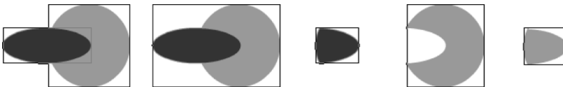
Rysunek 9.44. Dwa obiekty rysunkowe (najbardziej po lewej), dla których zastosowano różne polecenia łączenia obiektów (od lewej do prawej): Union (Łączenie), Intersect (Przecięcie), Punch (Dziurkowanie) i Crop (Kadrowanie)
